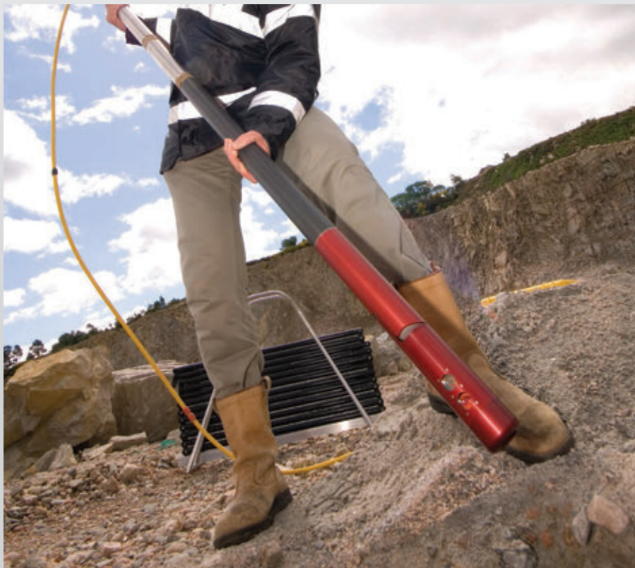
Видеокамера в передней части зонда обеспечивает полезный обзор ствола скважины во время развёртывания системы.
