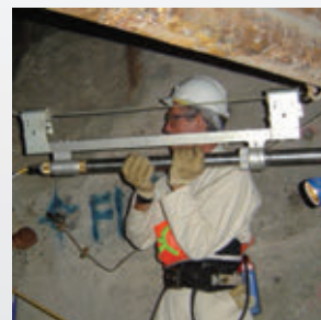
Система C-ALS, развёрнутая вниз по стволу скважины для исследования недоступной подземной полости.
